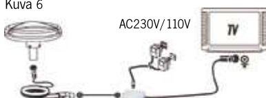
Asennus 1: Asennus suoraan televisioon (Kuva 6)
