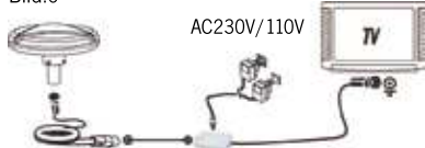
Installation 1: direkt anslutning till TV(Bild6)
