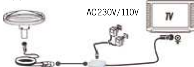
Installatie 1: Rechtstreekse aansluiting op de TV (Afb. 6)
