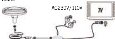
Installation 1: Direkt mit dem Fernseher verbinden
