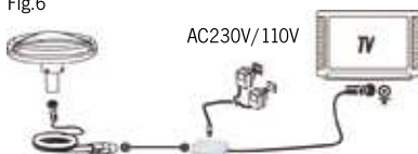
Installation 1: Connection directe à la télé (Fig. 6)
