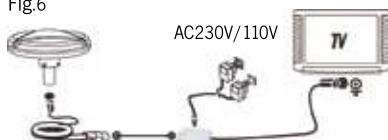
Installation 1: Forbindes direkte til fjernsynet (fig. 6)
