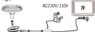
Installasjon 1: Koble direkte til tv-apparatet (fig. 6)
