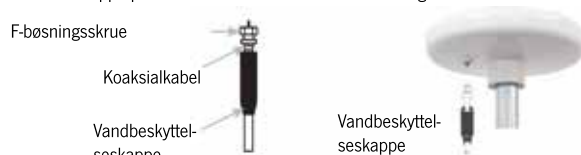
(Fig. 5) Stik koaksialkablets "F"-stik ind i antennen "F"-bøsning og fastgør den vandtætte kappe på enden af den tilsluttede "F"-tilslutning.
